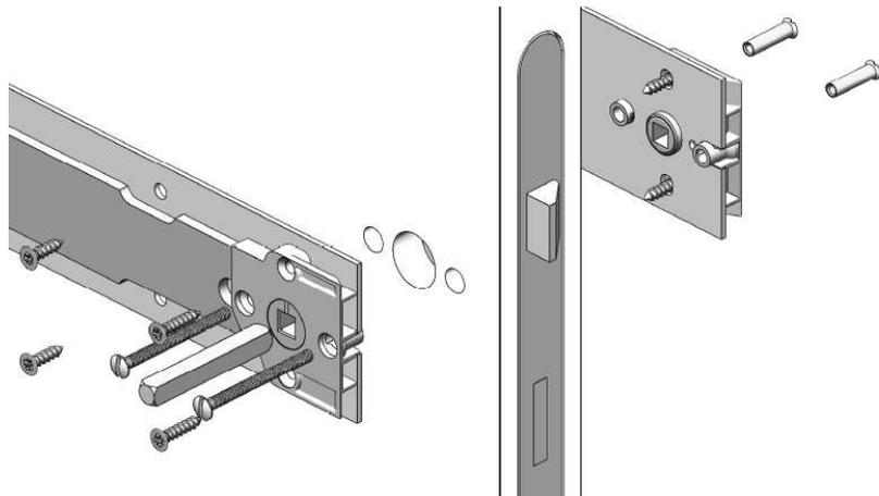
Utiliser deux demi ensembles Percés Fraisés et des vis bouchons pour fixer ensemble les deux Renvois de Mouvement.
