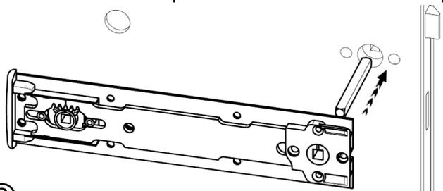
③ Fixer la poignée extérieure au travers du Renvoi de Mouvement. Utiliser les vis fournies avec les poignées
