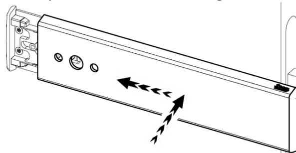
⑥ Insérer le carré court dans le fouillot du Renvoi de Mouvement. Fixer la deuxième poignée à l'aide de 2 vis M4x18. Clipser ensuite la rosette.
