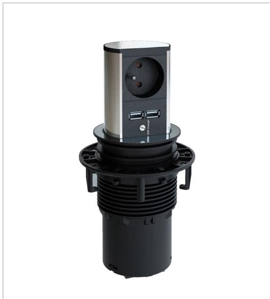
Pour une alimentation plus optimale de vos appareils électriques, choisissez la borne multiprise escamotable ELEVATOR Bachmann. Cette borne à **encombrement réduit** s'adapte à tous types d'environnement. Elle se fixe facilement à votre meuble grâce à une contre-bague. Facile d'usage, la borne multiprise se déploie et s'abaisse d'une **simple pression du doigt**.
