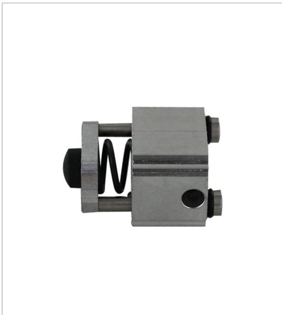
Si le chant de la porte à galandage doit affleurer le bord du châssis en position rentrée, il est recommandé de remplacer la butée fournie avec le kit par cette butée à ressort. Elle permettra l'extraction du vantail, pour une meilleure saisie, après une pression sur son chant.
