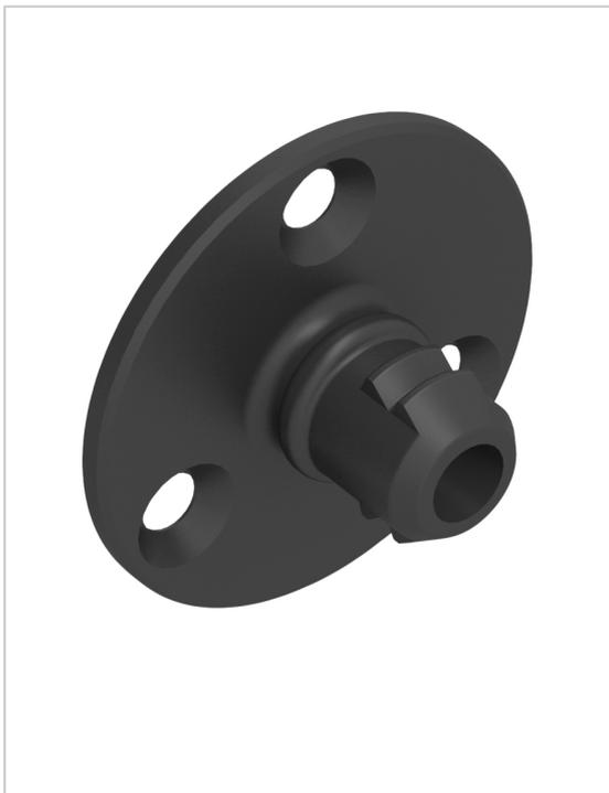
Le clip mâle PC-SVMX est un clip de très haute tenue avec une charge de retrait de 15kg et une résistance élevée au cisaillement (100kg). Il est conçu pour le montage de panneaux de plafond ou muraux lourds.
