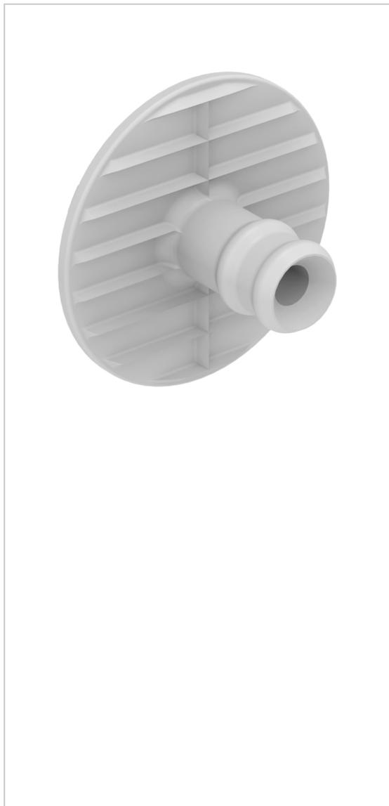
Le SL-M18 se fixe sur le panneau et se clipse sur le clip femelle SL-FA ou le SL-FB ou le SL-SFA pour permettre un montage rapide de panneaux lourds sur des rails alu ou fourrures acier.
