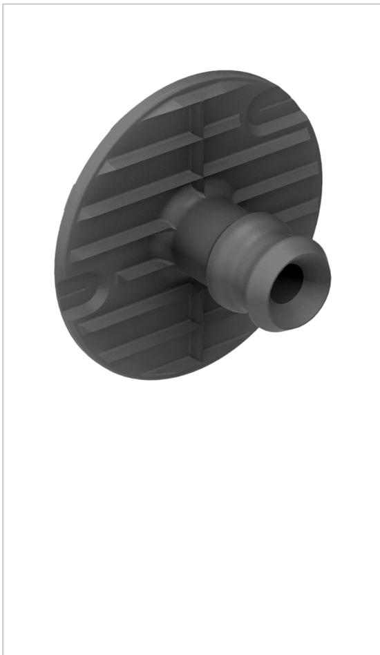
Le clip mâle SL-M18FR se fixe sur le panneau et se clipse sur le clip femelle SL-FAFR ou le SL-FBFR ou le SL-SFAFR pour permettre un montage rapide de panneaux lourds sur des rails alu ou fourrures acier.
