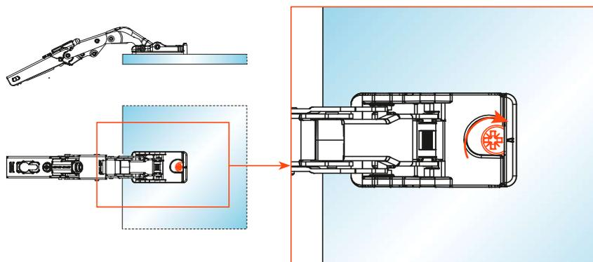
**3)** Tourner la vis excentrique de fixation.
