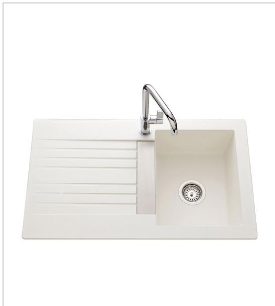
Ces éviers, en résine de synthèse composée de résines polyester, de fibres de verres et de charges minérales, sont recouvert d'une couche protectrice à base de résine polyester et de microbilles de verres rendant la surface dure, non poreuse, hygiénique, et d'un bel aspect.
