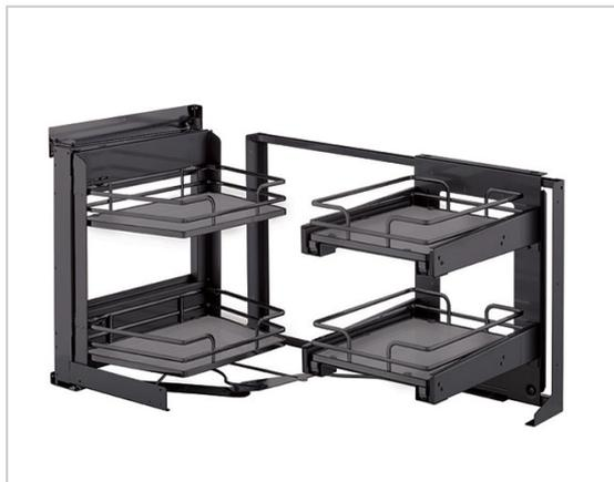
L'ouverture de la porte entraîne l'extraction du cadre pivotant faisant ainsi coulisser face à l'ouverture les corbeilles situées dans l'angle mort du meuble permettant ensuite de les extraire vers l'extérieur.
