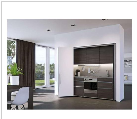
Le système HAWA-Folding Concepta permettra, dans une pièce, de concevoir une cloison escamotable totale (sol-plafond) ou partielle (plan de travail - plafond) entre 2 espaces.
