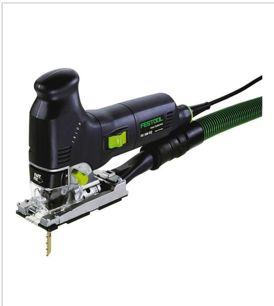
La scie sauteuse pendulaire TRION est robuste, puissante et ergonomique. Le triple guidage de lame à réglage parallèle des joues en acier carbure garantit une précision absolue de la lame, le pare-éclats permet d'éviter les retouches. Grâce à son ergonomie parfaite et son centre de gravité idéal, la TRION se laisse guider aisément, même dans une utilisation à main levée.
