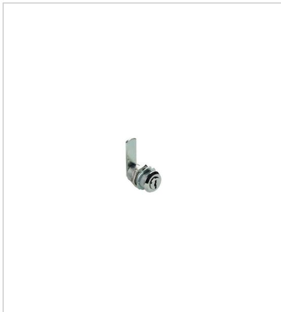
Cette serrure batteuse de marque Ojmar permet une fermeture optimale de vos meubles. Elle possède un **cylindre de 20 mm de diamètre** et 30 mm de longueur. Son corps et son barillet sont réalisés en zamack nickelé. Elle est livrée avec une came droite de 40 mm de hauteur, une **clé articulée et une clé nickelée**. Pour la version variée, chaque serrure a sa propre clé tandis que pour la version s'ouvrant, une même clé peut ouvrir tout un lot de serrures.
