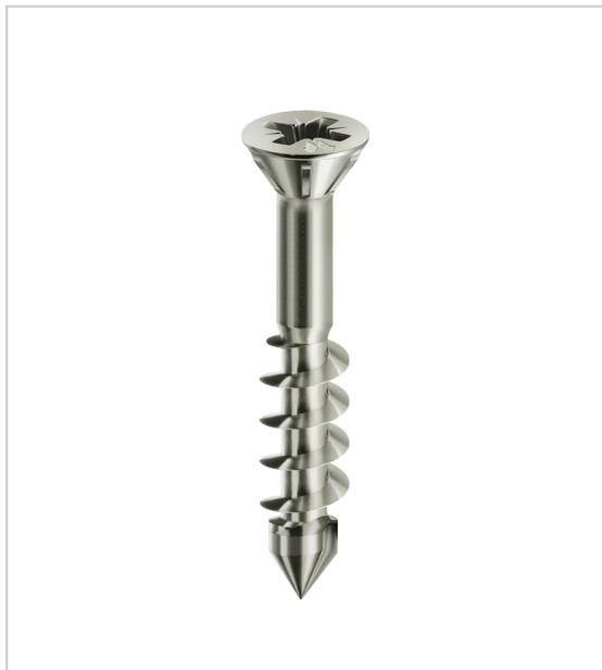
Vis tête fraisée cruciforme (PZ) - traitement galvanique Chromiting (résistance à la corrosion 5 fois supérieure au zingage blanc). Filetage partiel pour un serrage optimal et rapide.
